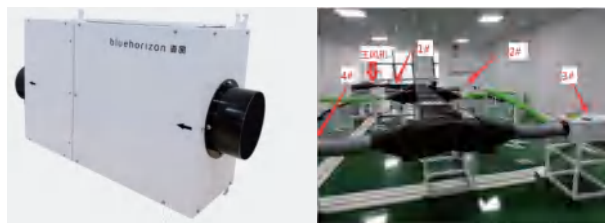
(a) 自适应支路风机 (b) 系统实验台实景图
